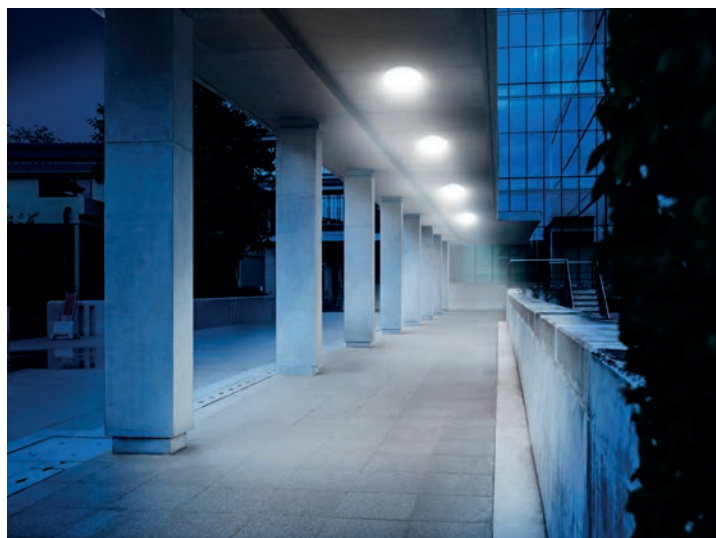
Sensorarmatur RS PRO PIR kan sammankopplas i grupp, en perfekt funktion när man vill tända alla armaturer samtidigt i passage, trapphus eller korridor.
